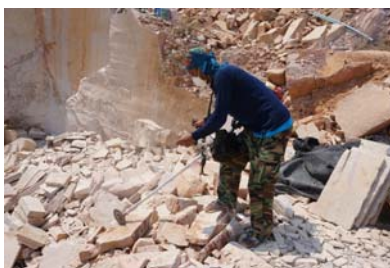
หลังตัดอุปกรณ์ลดฝุ่น (มีปริมาณฝุ่นลดลงมากกว่าร้อยละ 80)
